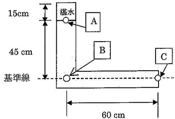
(1) A、BおよびC各点における圧力水頭を求めなさい。
