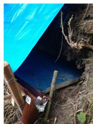
森林斜面で表面流を収集する装置を設置している。得られた表面流フィルタリングして得られたSSと水溶液中に含まれる放射性セシウムの量と割合を求め。
