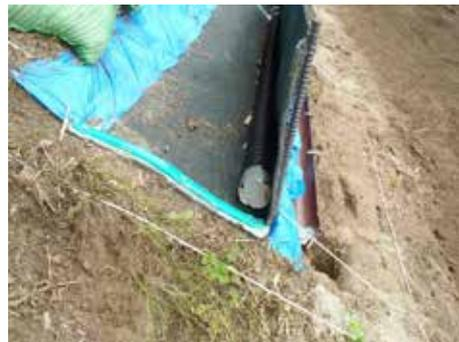
写真2 試験区下端の柵周辺の設備状況。柵の内側に透水性マットが敷かれ、セシウム吸着材が置かれた。柵の下方に雨樋を利用した集水設備を設けた。雨樋に直接雨が降り込まないように、常時、樋上方は遮水シートで覆った。
